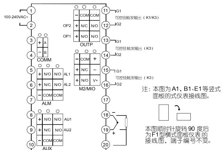
本图顺时针旋转90度后为F1型横式面板仪表的接线图，端子编号不变。
